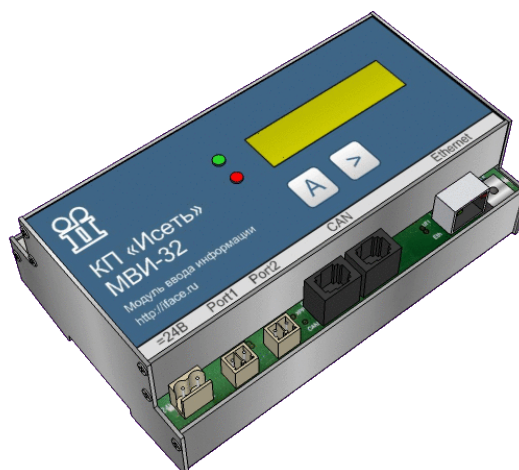
Рисунок 7 - Внешний вид и размеры контроллера «МВИ-32»
