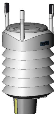
Рисунок 10 - Внешний вид метеостанции WXT520
